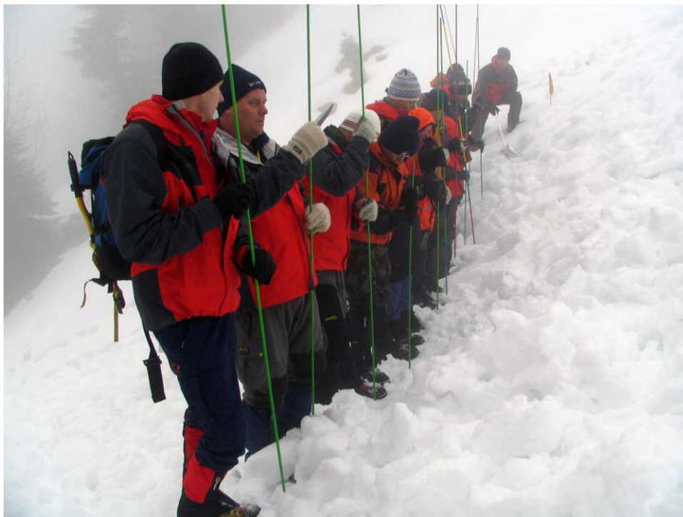
Kratke, z navojnim vretenom sestavljive lavinske sonde.
